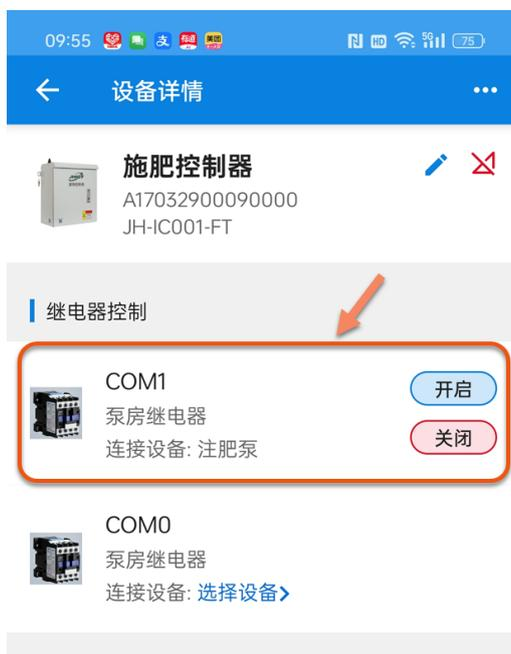
3. 在上面的【施肥控制器详情页】中，我们可以通过 COM1 继电器的【开启】和【关闭】按钮来手动远程控制（COM1 口连接的）注肥泵的开启和关闭。
